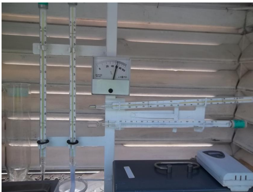
Obrázek 1 - Měření teploty a vlhkosti v meteorologické budce
